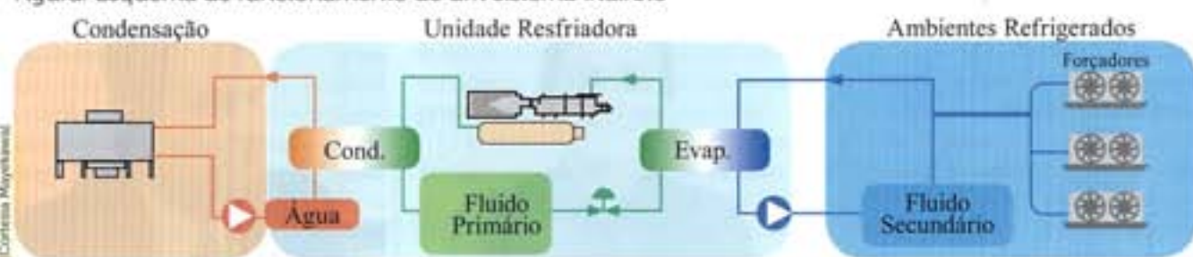
Figura: Esquema de funcionamento de um sistema indireto
