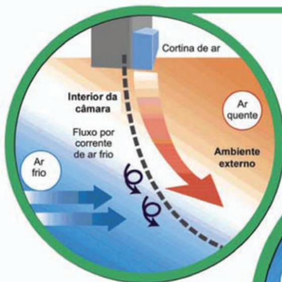
A cortina de ar convencional insufla o ar verticalmente, enfraquecendo o insuflamento na área inferior onde há maior fluxo de ar frio, dificultando o bloqueio do ar.
