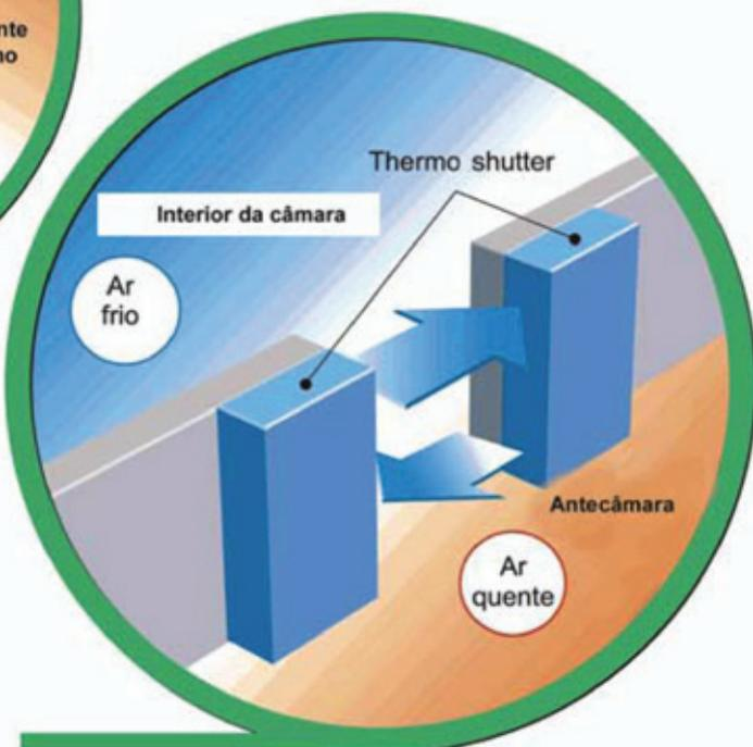
O Thermo Shutter insufla o ar horizontalmente, mantendo a velocidade de ar e pressão por toda a extensão da porta, proporcionando um bloqueio eficiente.
